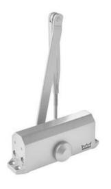
регулируется винтом № 2. При повороте против часовой стрелки скорость увеличивается, по часовой – уменьшается. Регулировочные винты расположены на торце тела доводчика и отмечены цифрами 1 и 2 соответственно.
